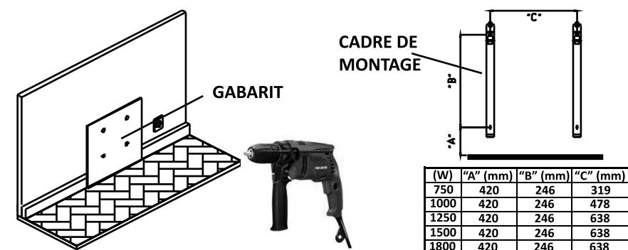
2) Une fois les 4 trous réalisées, introduire les 4 chevilles de 8mm et fixez le cadre de montage au mur à l'aide des 4 vis 5,5 x 60 mm fournies.
