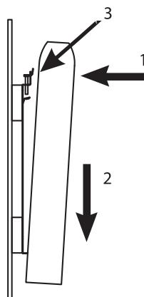
① et ② Placer et fixer l'appareil en partie haute sur les pattes prévues à cet effet. Appuyez vers le bas pour enclencher.
